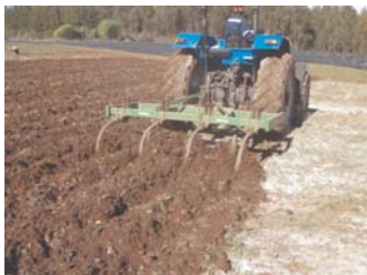
Rastraje y cincelado para mullir y homogeneizar el suelo
