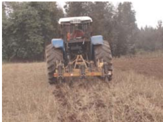
Subsolado para descompactar el suelo
